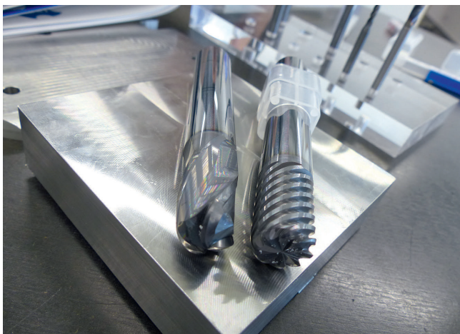
2 Die Torus- und Kugelfräser der AM-Serie sind mit ihrem negativen Spanwinkel und ihrer hohen Hitzebeständigkeit und Zähigkeit für das Spanen 3D-gefertigter Teile prädestiniert (© OSG)
